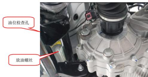
图 3 E100 电动汽车差速器油的更换
