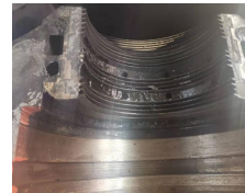
图6 2021年检修高压端轴封
